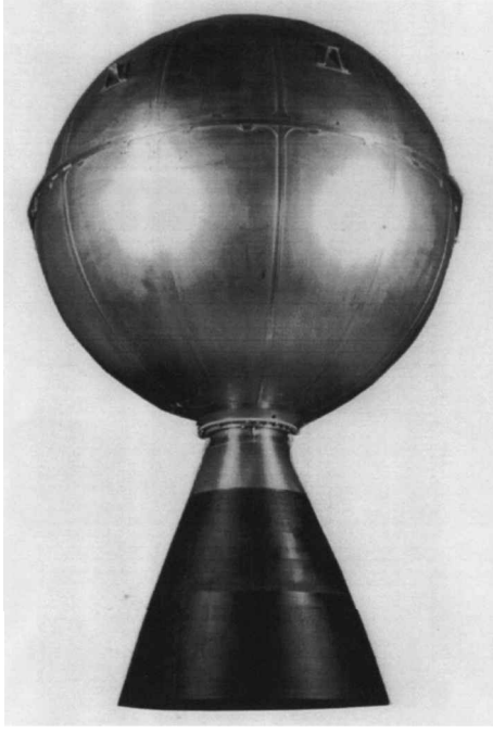
Fig. 1 AUS-51 upper-stage motor.
